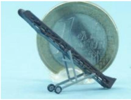
Nach dem Ätzen werden die Teile dann aus den Resten herausgetrennt. Da die Knickstellen der Teile bei Neusilber nicht sonderlich sicher sind, habe ich alle Knicke zur Stabilisierung noch einmal verlötet. Wenn das Förderband komplett ist wird es in Seifenlauge gereinigt, grundiert und schließlich mit der entsprechenden Farbe lackiert. Dann wird noch das Band aus Papier eingeklebt und fertig ist das Förderband.
